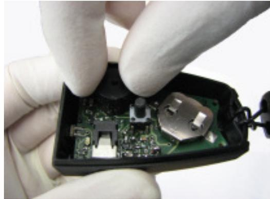
**Abbildung 7: Entnahme der Elektronik**
