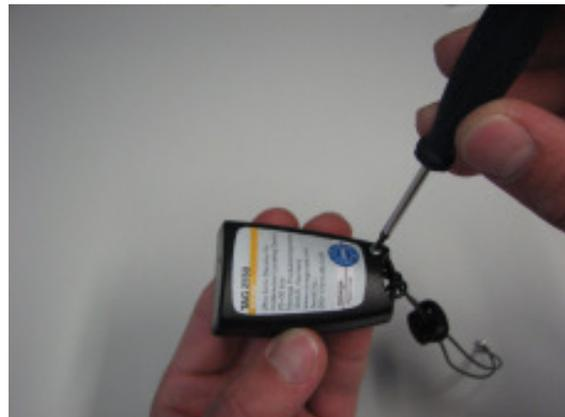
Abbildung 5: Entfernen der Schraube an der Rückseite des TAG 2550
